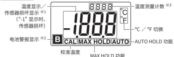
※1 传感器断裂时，会显示传感器损坏。请更换新的传感器。
